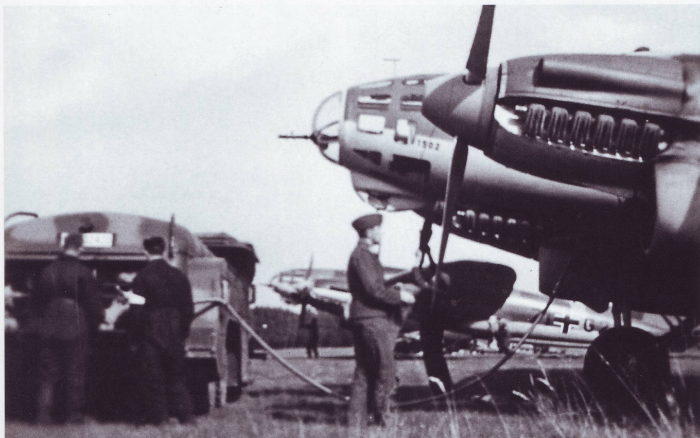
Die 71+G24, eine He 111 B-1 der II./KG 157 "Boelcke", sowie die im Vordergrund stehende He 111 B-2, wurden auf einem süddeutschen Einsatzhorst für einen Übungsflug bereit gemacht. Hierbei wurde die Maschine mittels eines Flugbetriebsstoffkesselwagens (Kfz. 384) betankt.
