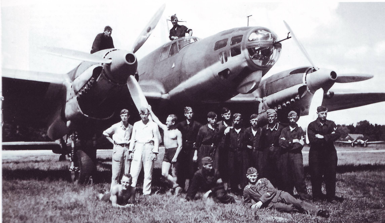
Zusammen mit dem Ersten Wart haben sich alle für diese He 111 B-1 zuständigen Techniker zu einem Erinnerungsfoto zusammengefunden. Unter dem Rumpfbug ist das stromlinienförmig verkleidete Bombenvisier zu erkennen. Ab Sommer 1940 wurden mindestens 210 B-1 im Rahmen einer Umbauaktion in B-2 umgerüstet. Together with the crew chief, all technicians responsible for this He 111 B-1 gathered for a memorial photo. Below the front fuselage the aerodynamically shaped bombsight is visible. Beginning in summer 1940, at least 210 B-1s were converted to B-2s. (AirDOC Collection)
