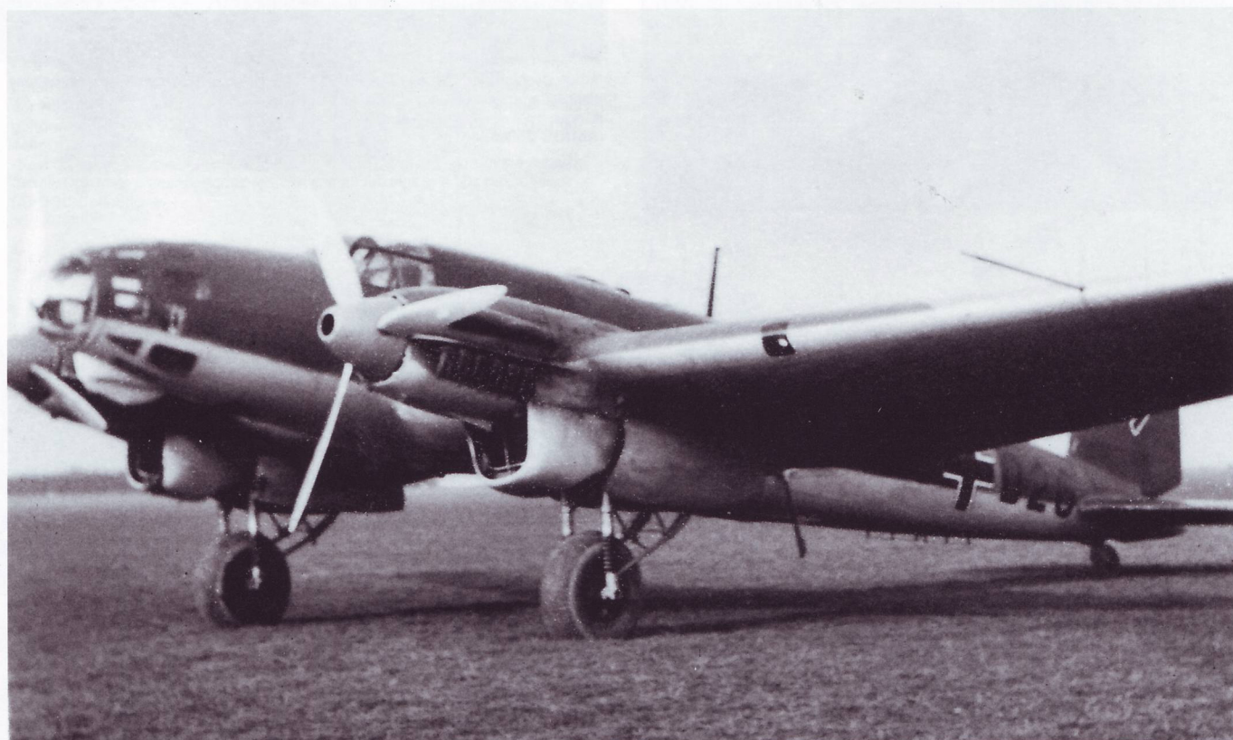
Mittels zweier DB 600 CG-Reihenmotoren konnten viersitzige Maschinen wie diese späte Ausführung der He 111 B-2 in 4.000 m Einsatzhöhe eine Geschwindigkeit von knapp über 400 km/h erreichen. Die Dienstgipfelhöhe belief sich auf 7.000 m. Bereits Ende der 30er Jahre waren solche Leistungen für den offensiven Einsatz kaum noch ausreichend, so dass die Abgabe an Kampffliegerschulen erfolgte. With the help of two DB 600 CG in-line engines, four-seat aircraft like this late version of the He 111 B-2 could reach a speed of almost 400 km/h at 4,000 m altitude. The service ceiling was 7,000 m. By the late 1930s, a performance as such was barely sufficient for offensive missions so the aircraft were relegated to the bomber schools. (AirDOC Collection)
